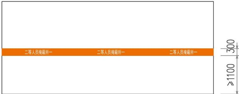
图 3.7.6-1 墙面喷涂标识线
