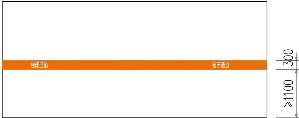
图 3.7.7 密闭通道墙面喷涂标识线
